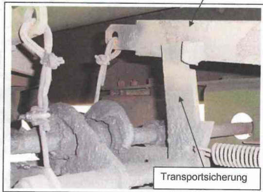
Abb. 41 Blick auf Transportsicherung (ordnungsgemäß verriegelt)
