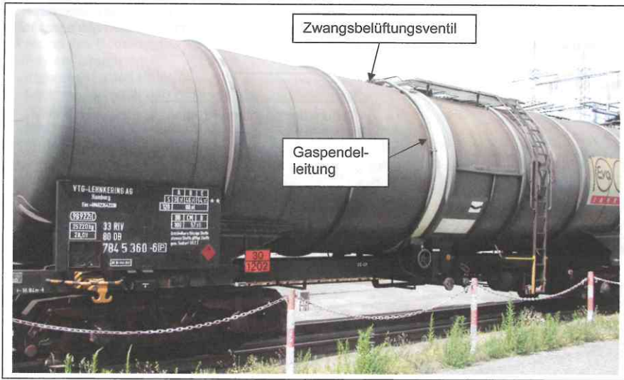
Abb. 7 Mineralölkesselwagen mit Zwangselüftungsventil und Gaspendelleitung
