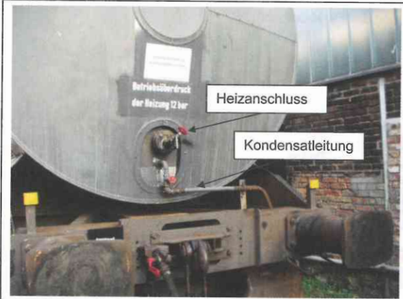
Abb. 22 Heizanschluss eines EKW
