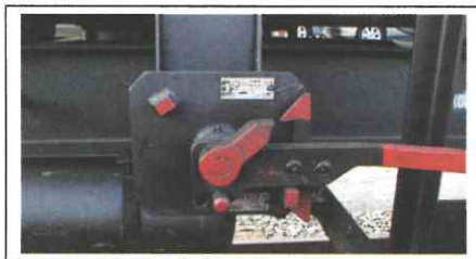
Abb. 12 Ventilstellungsanzeiger zeigt geöffnetes Bodenventil
