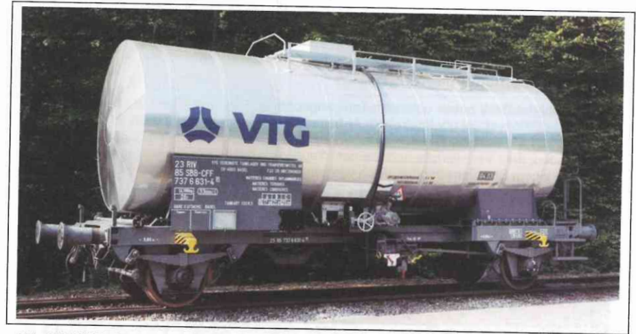
Abb. 27 EKW mit oberen und unteren Befüll- und Entleerungsarmaturen
